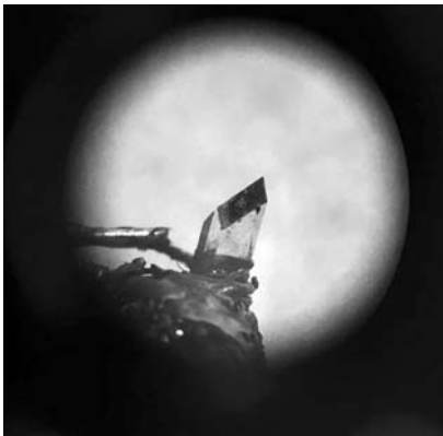
8 pav. Per mikroskopą matoma deimantinė vinilinių plokštelių pjovimo adata
